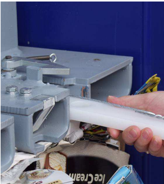
Bild 5-26 Drahtziehhaken im Pressschild
