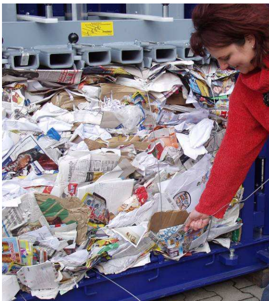
Bild 5-30 Strammziehen des Drahtes
