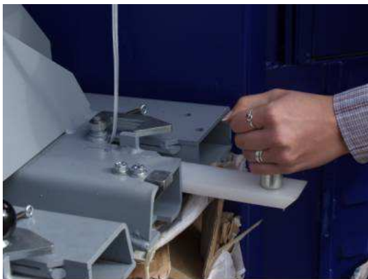
Bild 5-20 Bandziehhaken aus dem Bandkanal ziehen
