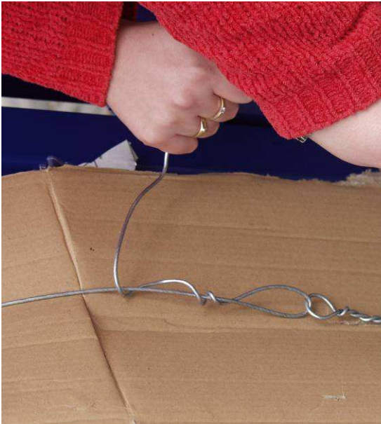
Bild 5-31 Verdrillen des Drahtes
