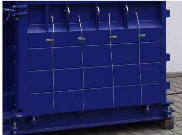
Bild 5-25 Draht in Federklammer
