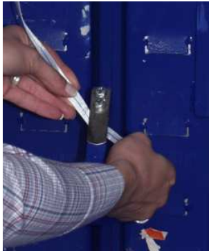
Bild 5-7 Band unter Federblech des Auswerfers
