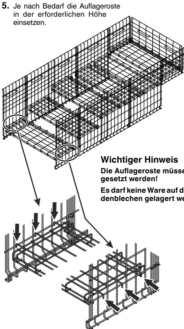
Detailansicht des korrekt eingesetzten Trengitters
