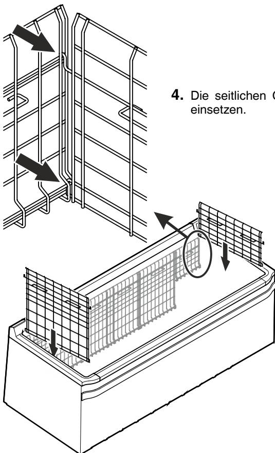
6. Je nach Gerätetyp die Auflageroste in der angegebenen Reihenfolge einsetzen.
