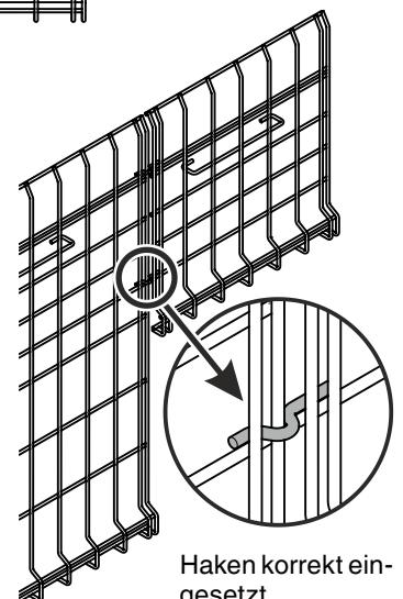
2. Die Gitterroste vorne und hinten einsetzen.
