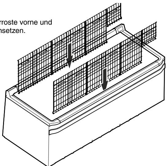
3. Die Bodengitterroste einsetzen.
